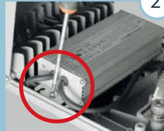
Desconecte los cables de la entrada de línea y afloje los dos tornillos a ambos lados del driver.
