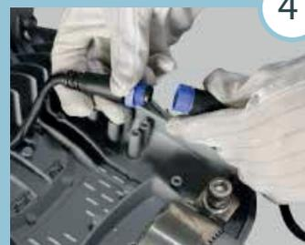
Desconecte los conectores macho y hembra entre el driver y el módulo, a continuación extraiga y cambie el driver defectuoso. Organice los cables y fije el driver a la luminaria con los dos tornillos, luego cierre la cubierta.
