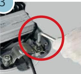
Paso 3: Afloje los dos tornillos de cabeza hexagonal de la abrazadera.
